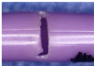
Figura 1: Exemplu de fisură transversală/circumferențială în corpul cateterului
